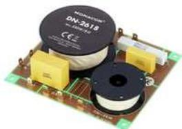
**Filtres** : Associées aux condensateurs, ils forment un circuit oscillant utilisé comme filtres, circuits résonnants ou corrigeant la courbe de réponse d'un système électronique (dans les circuits audio par exemple)
