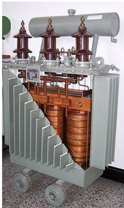
**Transformateur** : On utilise 2 bobines en regard. L'une étant alimentée en électricité crée un champ qui traverse l'autre. L'autre étant traversée par ce champ crée une tension à ses bornes en suivant la loi de Lenz.
